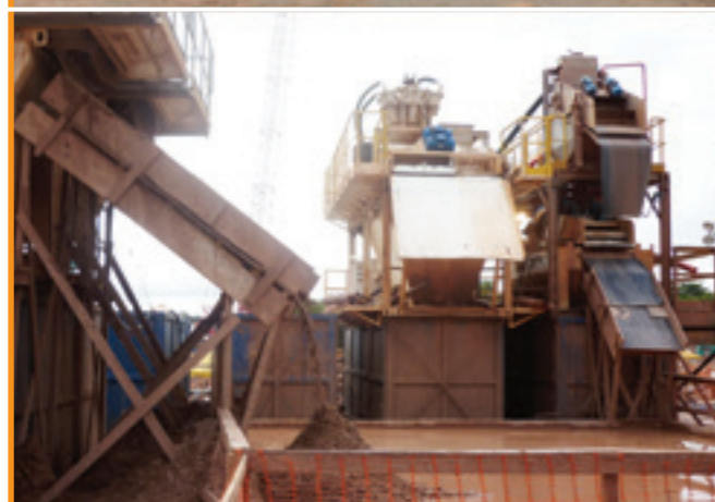
Centrais desarenadoras de lama bentonítica para hidrofresa
