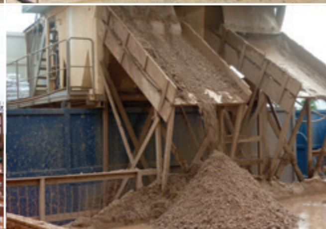
Centrais desarenadoras de lama bentonítica para hidrofresa
