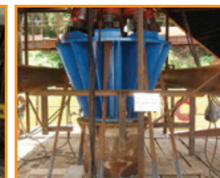
Prova de carga estática com tirantes de reação para 720 tf - Juruti - PA
